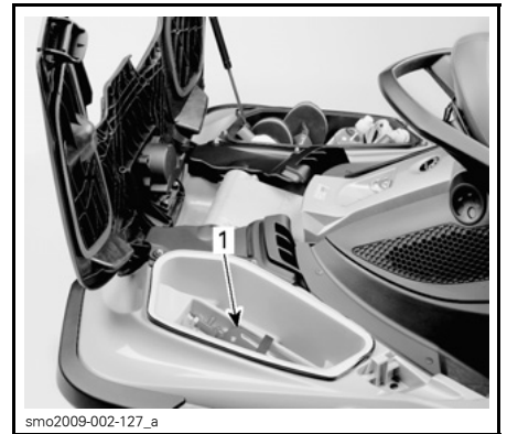
1. Lage des Feuerlöschers
